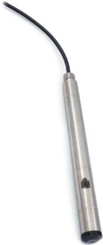
Sonde multiparametriche ad alta precisione made in Italy: misurano contemporaneamente la conducibilità, la temperatura e la profondità dell'acqua. Le dipendenze della temperatura e la non linearità vengono compensate automaticamente mediante un modello matematico dal microcontrollore integrato.
